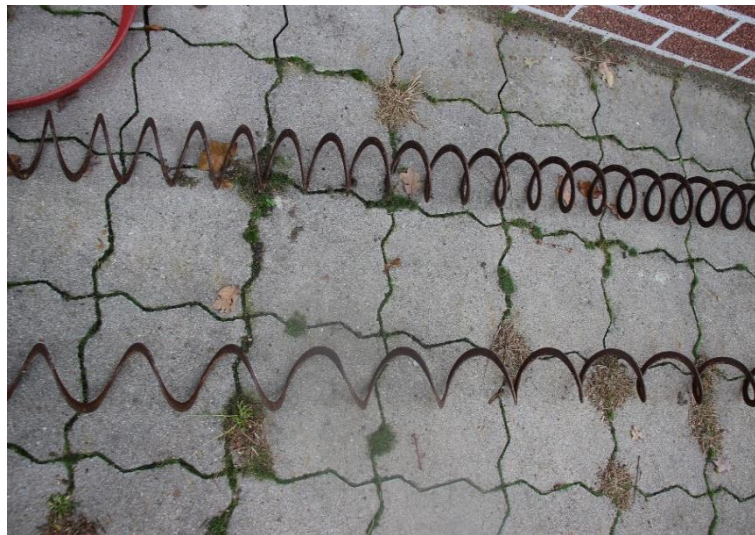
Abb. 7: oben im Bild: Normalzustand der Förderschnecke, unten im Bild: verbogene und verzogene Förderschnecke
