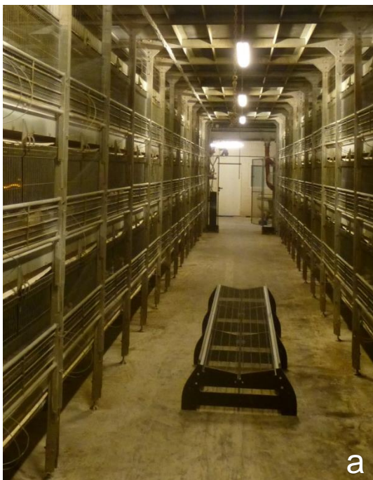
Abb. 34: Ansicht des im Aufzuchtstall installierten Probenstückes eines Muldenbandes zur automatischen Ausbringung von Beschäftigungsmaterial: im leeren Stall (a) bzw. zum Zeitpunkt der Beschickung (b)
