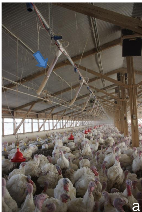
Abb. 78: Rohrfördersystem mit kurzen Rohren an den Dosierventilen im linken Teil des Stalls (a) und langen Rohren an den Dosierventilen im rechten Teil des Stalls (b)
